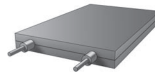
FIG. T - Encastrés entre des plaques
